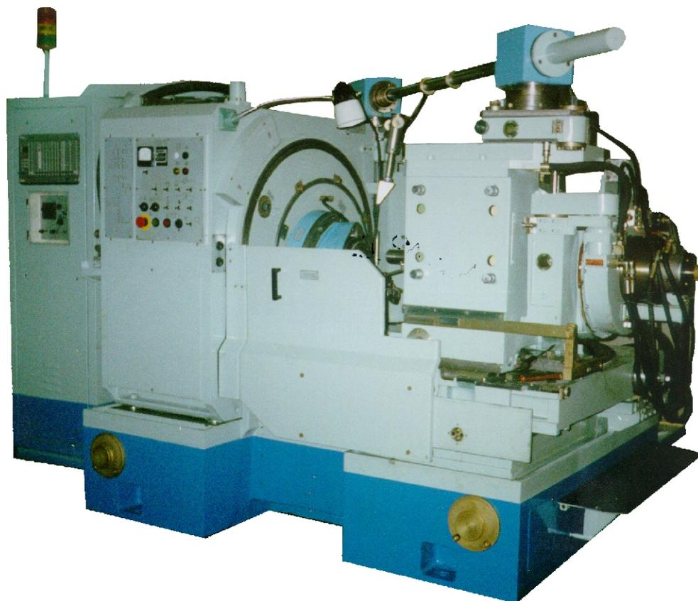
*ПОЛУАВТОМАТ ПРЕДНАЗНАЧЕН ДЛЯ ЧИСТОВОЙ И ЧЕРНОВОЙ ОБРАБОТКИ ЗУБЧАТЫХ КОЛЕС КОНИЧЕСКИХ И ГИПОИДНЫХ ПЕРЕДАЧ С КРУГОВЫМИ ЗУБЬЯМИ, ГЛАВНЫМ ОБРАЗОМ ДЛЯ ЧИСТОВОЙ ОБРАБОТКИ ВЕДУЩИХ КОЛЕС ПОЛУОБКАТНЫХ ПЕРЕДАЧ В УСЛОВИЯХ КРУПНОСЕРИЙНОГО И МАССОВОГО ПРОИЗВОДСТВА. ОБРАБОТКА ПРОИЗВОДИТСЯ ТОРЦОВОЙ ЗУБОРЕЗНОЙ ГОЛОВКОЙ.*
